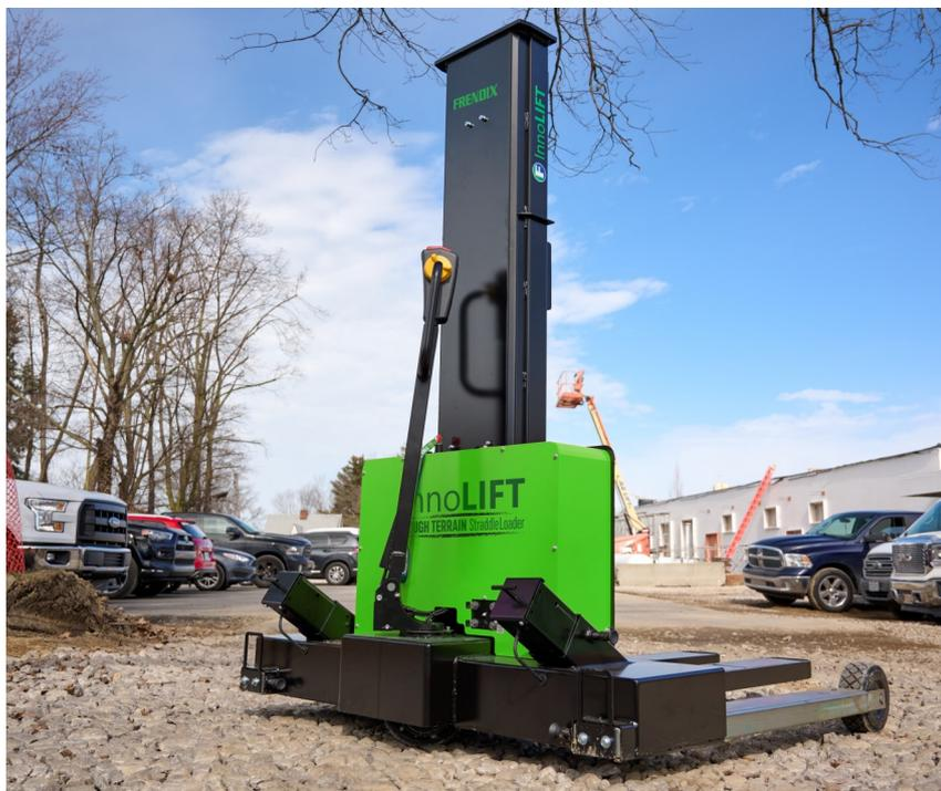
I nuovi **INNOLIFT ERT** grazie alle ruote off-road ed una trazione ancora più potente sono in grado di muoversi su qualsiasi terreno a pieno carico. Ghiaia, terra e fanghiglia: nulla può fermarli!
